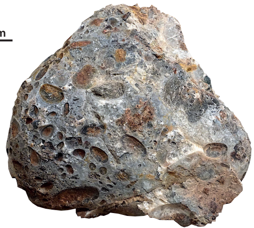
Abb. 11: Druckstellen auf der Oberfläche von Geröllen lassen erahnen, mit welchem Druck der Kies während der Diagenese zu Konglomerat verdichtet wurde.
