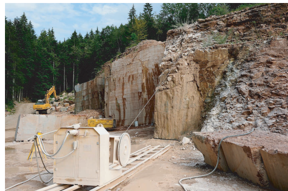
Abb. 3: Seilsäge im Kalksteinbruch Adnet (Österreich).
