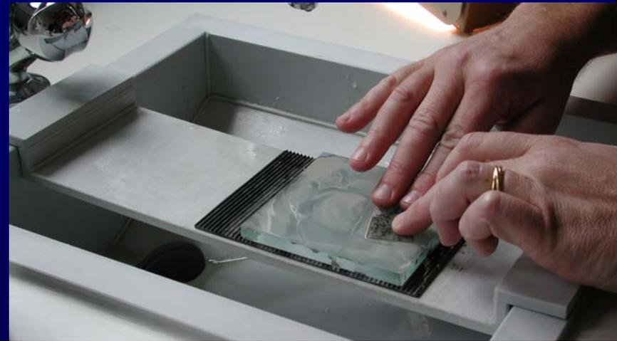
Der Dünnschliff wird auf der Glasplatte von Hand auf die gewünschte Enddicke (25 - 30  $\mu\text{m}$ ) geschliffen. Die Schliffdicke wird an Hand der Interferenzfarben mit einem Polarisationsmikroskop kontrolliert. Zuletzt wird ein Deckglas aufgeklebt.
