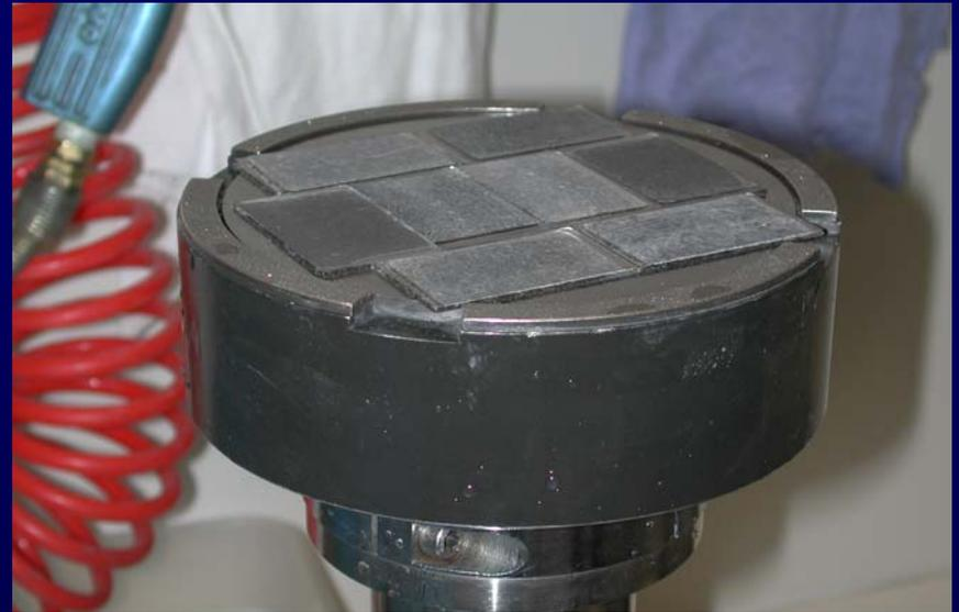
Der Läppkopf wird nun auf 40  $\mu\text{m}$  eingestellt. Max. acht Schliche können gleichzeitig darauf angesaugt und umgekehrt auf der Gusscheibe geläppt werden.
