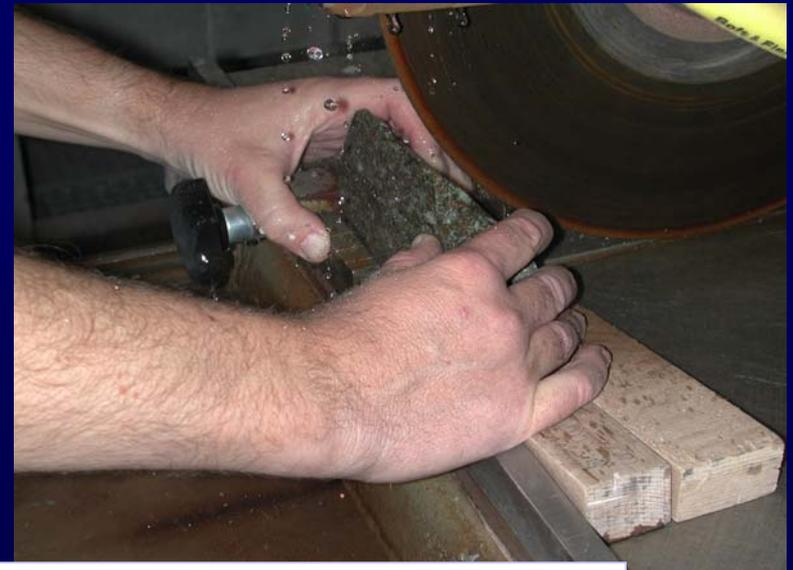
Die Handstücke werden mit einer Diamanttrennscheibe auf die Dünnschliff-Grösse zugeschnitten.
