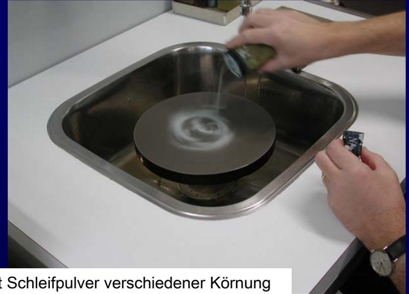
Die Dünnschliff-Klötzchen werden mit Schleifpulver verschiedener Körnung auf der rotierenden Gusscheibe angeschliffen. Anschliessend werden sie gereinigt und getrocknet.
