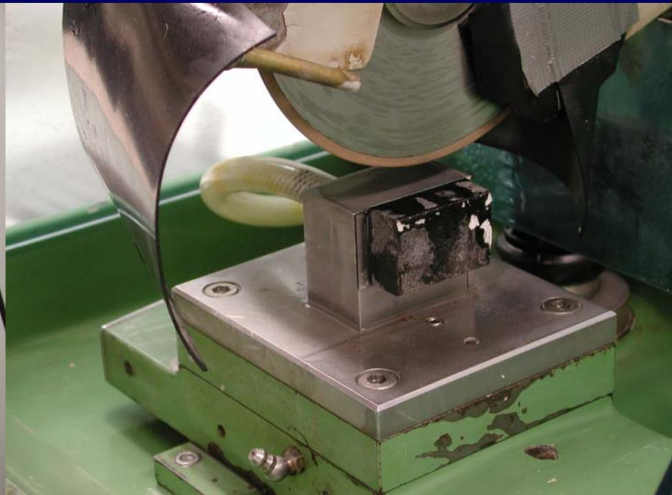
Das Klötzchen wird auf der Glasseite mit Vakuum an die Halterung der Säge angesaugt. Mit einer Diamanttrennscheibe wird die gewünschte Dicke von ca. 100  $\mu\text{m}$  abgesägt.
