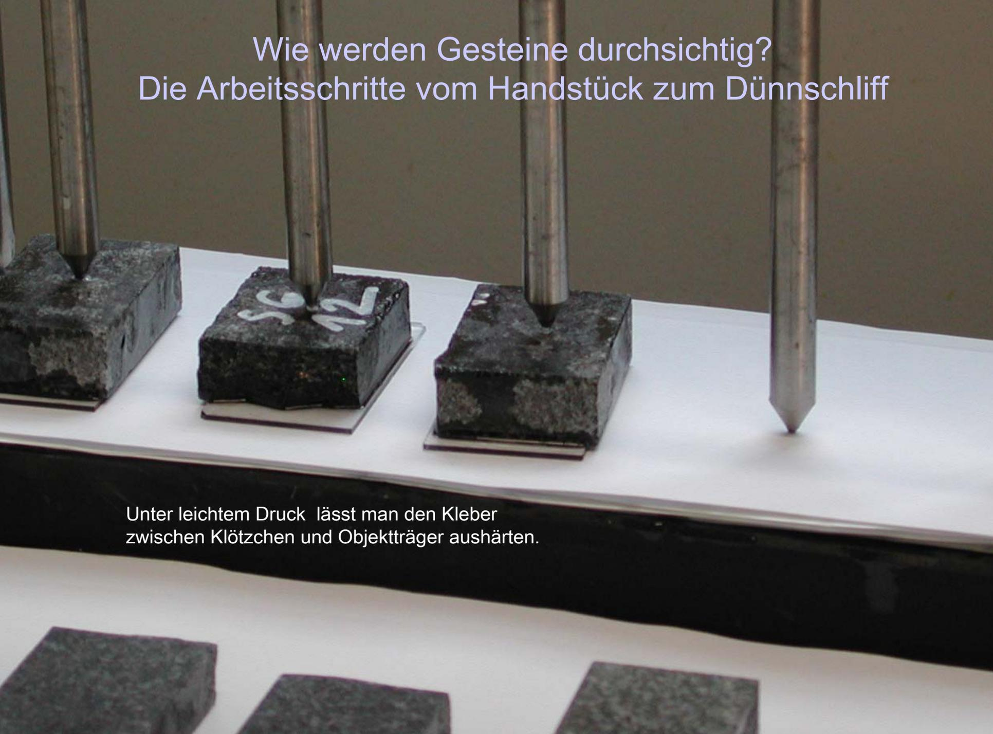
Unter leichtem Druck lässt man den Kleber zwischen Klötzchen und Objekträger aushärten.
