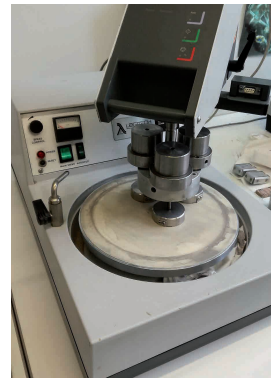
Polieren des Dünnschliffs (eingeklemmt unter den Stahlstempel)
