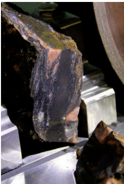
Sägen des Gesteins mit der Diamantsäge.
