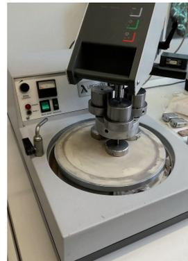
Polieren des Dünnschliffs (eingeklemmt unter den Stahlstempel)
