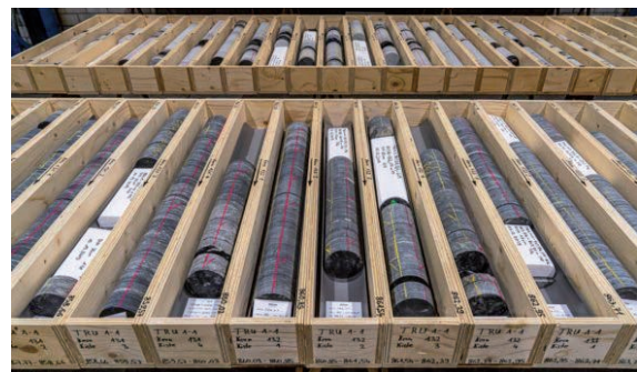
Abb. 27: Bohrkern, die mit einem Hohlbohrkopf aus dem Gestein heraus gefräst wurden (Kernbohrung). Bei kostengünstigen Meißelbohrungen wird auf den Einsatz eines Hohlbohrkopfes verzichtet. Dann muss es reichen, die Gesteinssplitter zu untersuchen, welche von der Bohrflüssigkeit aus dem Bohrloch an die Oberfläche geschwemmt werden.
