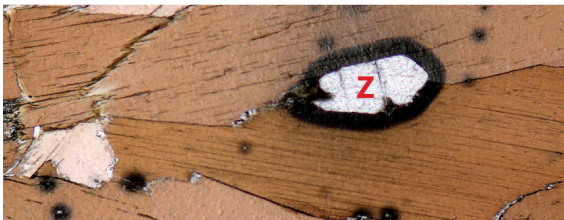
Abb. 11: Zirkonkristall (Z) in Biotit. Der schwarze Rand im Biotit entsteht durch die radioaktive Strahlung des Urans im Zirkon (Dünnschliff, ca. 20-fache Vergrößerung).
