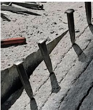
Spalten von Gneis zu Platten.
