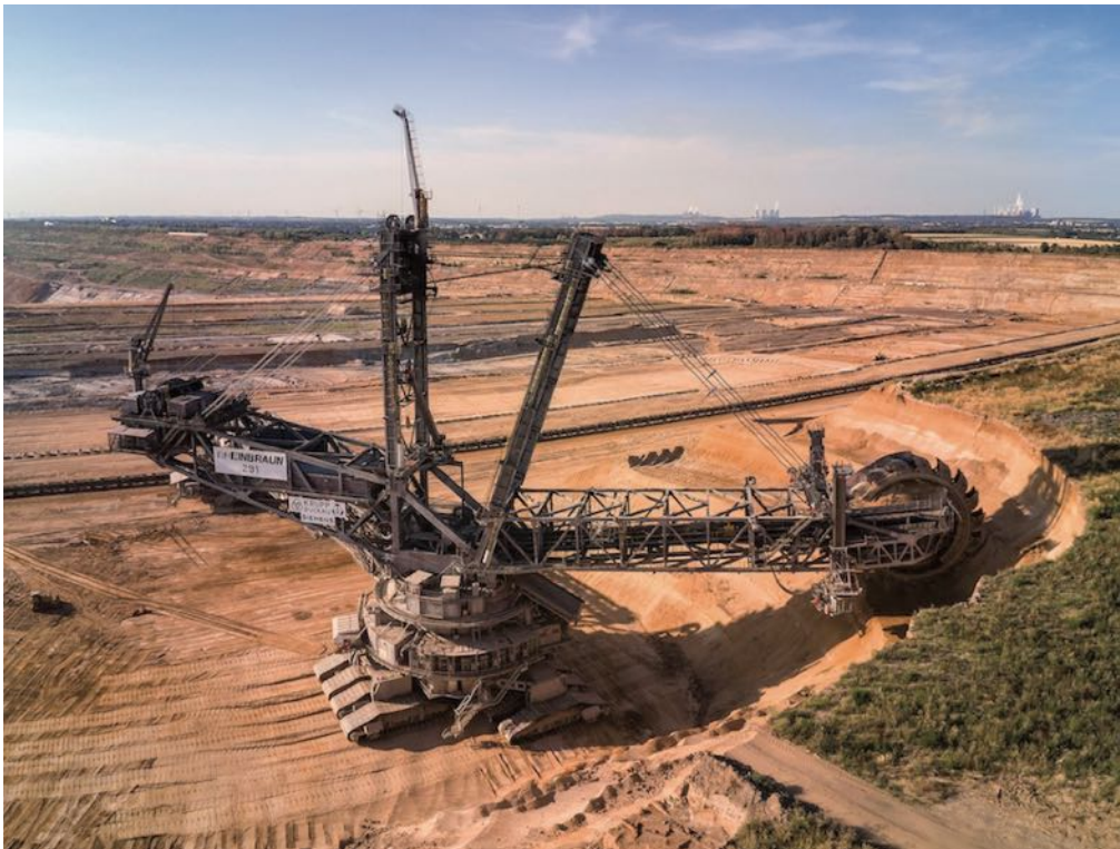
Abbau der Decksedimente, Hambach, D, 2018
