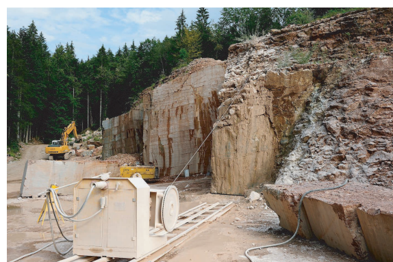
Abb. 8: Seilsäge im Kalksteinbruch Adnet (Österreich).
