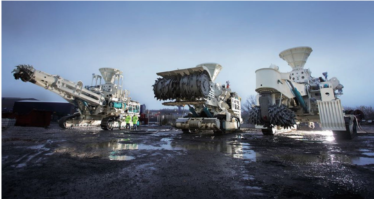
Ferngesteuerte Abbaumaschinen, sogenannte Seafloor Production Tools . Beachte die gelb gekleideten Personen als Massstab ( www.dsmobserver.com ).
