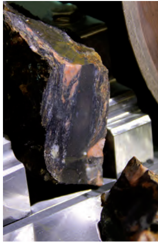
Sägen des Gesteins mit der Diamantsäge.
