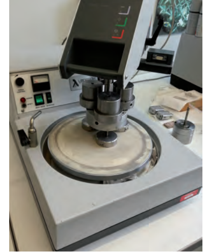
Polieren des Dünnschliffs (eingeklemmt unter den Stahlstempeln)
