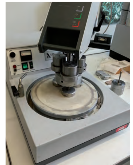
Polieren des Dünnschliffs (eingeklemmt unter den Stahlstempeln)
