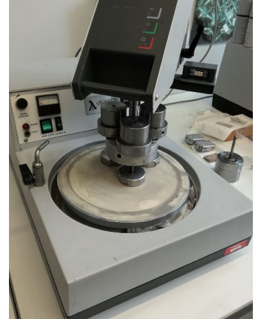
Polieren des Dünnschliffs (eingeklemmt unter den Stahlstempeln)
