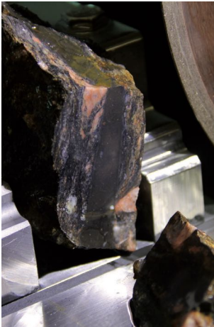
Sägen des Gesteins mit der Diamantsäge.
