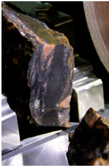
Sägen des Gesteins mit der Diamantsäge.
