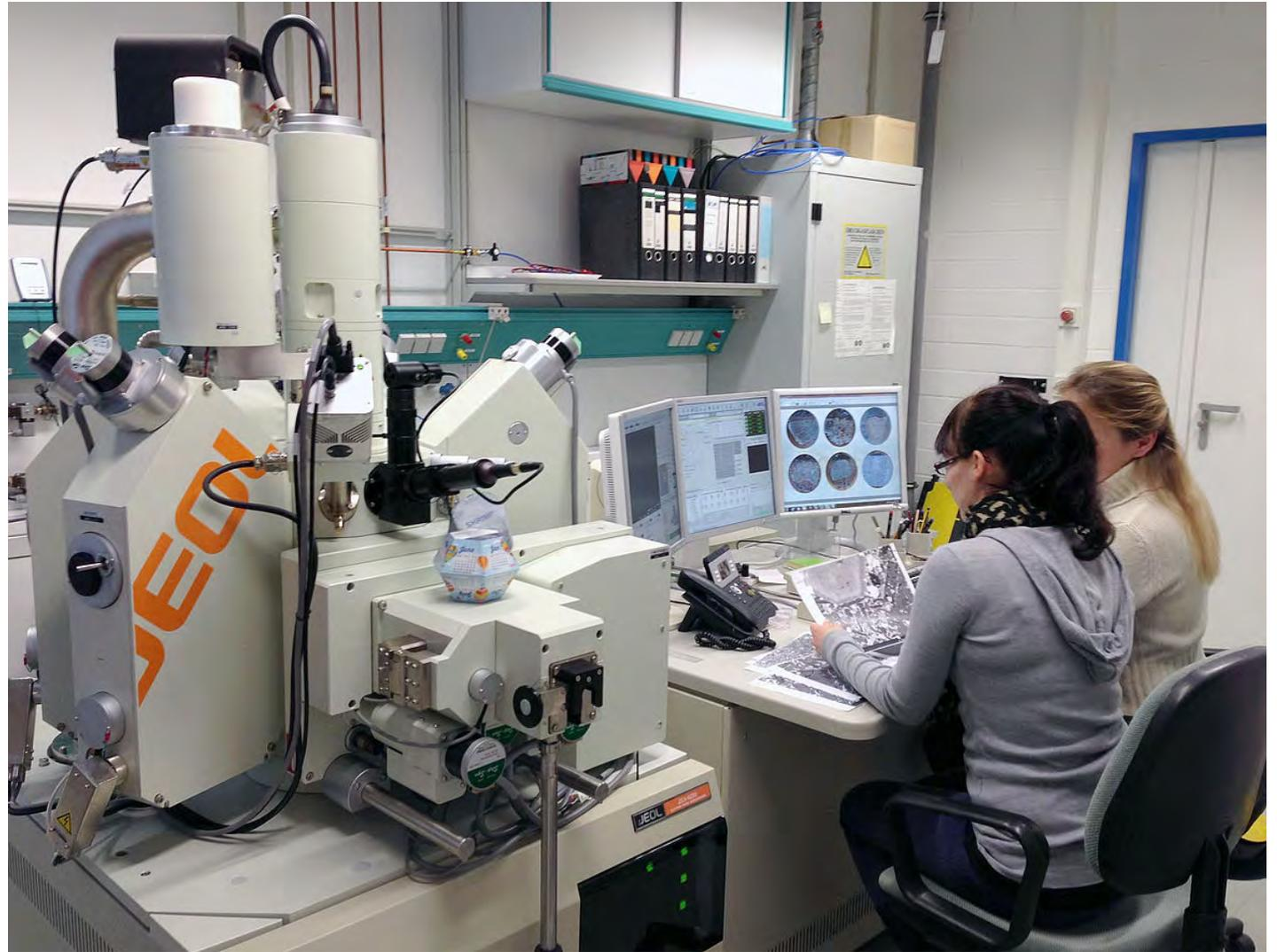
Elektronenmikrosonde neuester Bauart. Diese ermöglicht die chemische Analyse jedes beliebigen Punktes innerhalb eines Gesteins.
