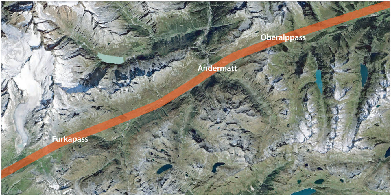
Abb. 5: Die Urserenzone zieht entlang wenig erosionsresistenter metamorpher Sedimentgesteine und anderer Gesteine, die zum Teil während der alpinen Orogenese stark zermürbt wurden, über Furka- und Oberalppass.
